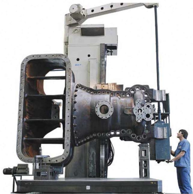
As carcaças superior e inferior são unidas através de prisioneiros de alta liga, uniforme e termicamente pré-tensionados, o que assegura uma perfeita vedação.
