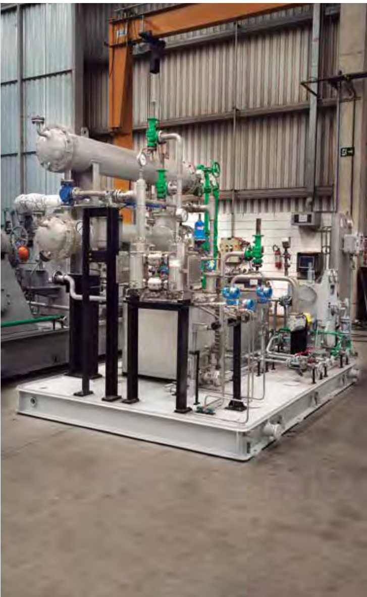
Sistema de óleo projetado conforme requisitos da Norma API 614.
