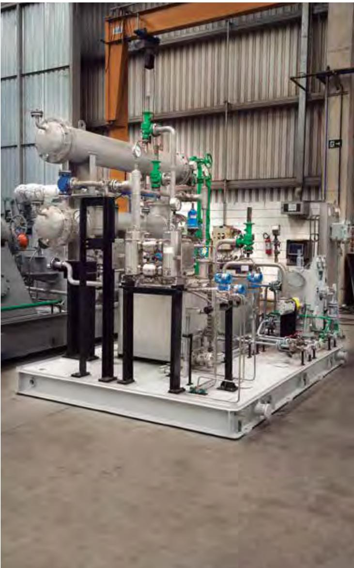
Sistema de óleo projetado conforme requisitos da Norma API 614.
