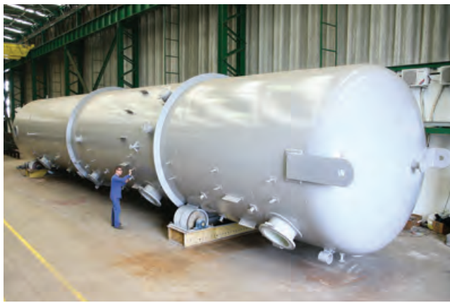
Torre de Desaeração/ Deairing Column Ø 3.800 mm a/h - 22.200 mm p/we - 50.000 kg
