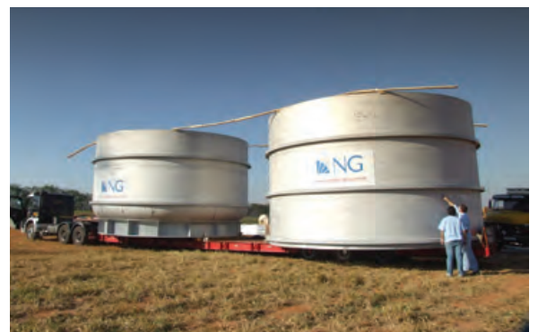
Fermentadores/ Main Fermenters c - 423 m 3 a/h - 11.500 mm Ø - 7.300 mm
