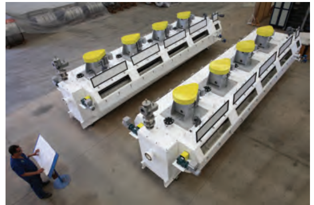
Flotadores/Flotators c - 110 m 3 /h co/l - 7.800 mm la/w - 2.100 mm p/we - 7.000 kg
