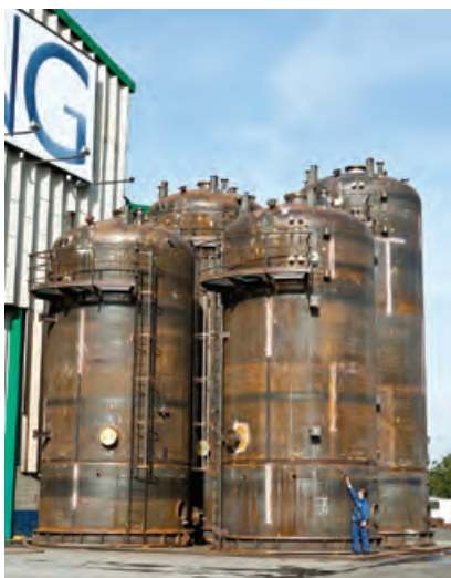
Flotador/ Flotation Cell a/h - 13.000 mm Ø 4.800 mm
