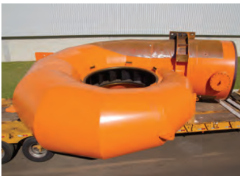
Caixa espiral com pré-distribuidor/ Spiral Case 7.300 x 8.300 mm Ø - 2.500 mm p/we - 15.000 kg
