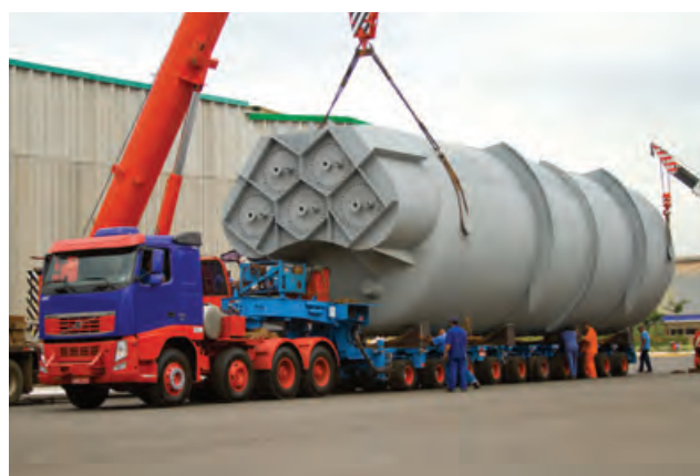
Forno de enxofre/ Brimstone Furnace co/l - 19.800 mm Ø - 5.200 mm p/we - 76.000 kgf
