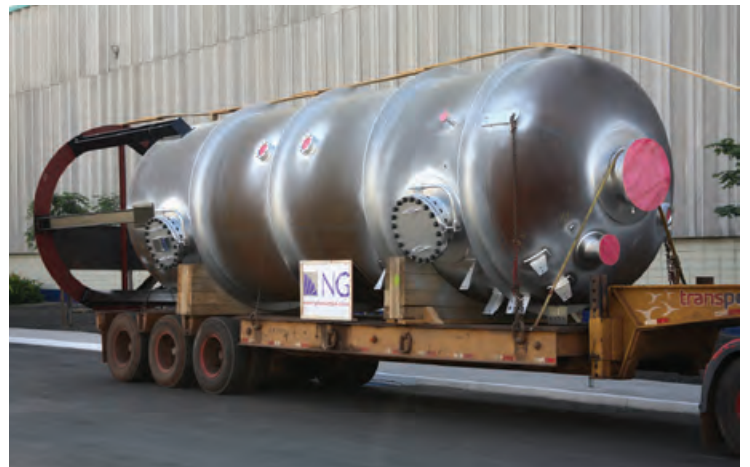
Torre de Desaeração/ Deairing Column Ø 3.800 mm a/h - 22.200 mm p/we - 50.000 kg
