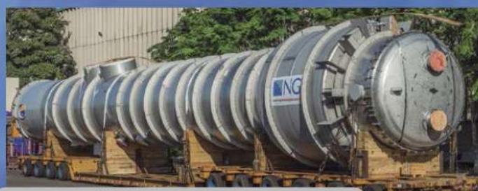
Evaporador, Ø 2.800 mm x 28.000 mm. Peso - 80t.
