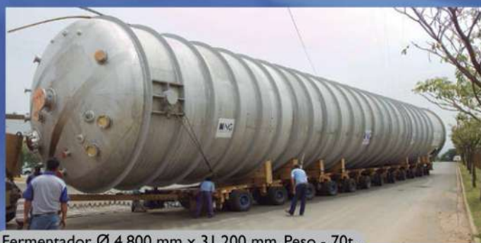
Fermentador, Ø 4.800 mm x 31.200 mm. Peso - 70t.
