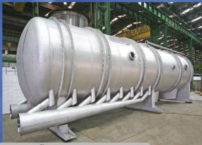
Desaerador, Ø 2.700 mm x 11.700 mm. Peso - 20t.
