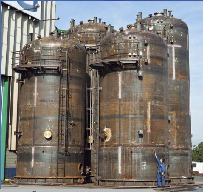
Flotadores, Ø 4.800 mm x 13.000 mm (H). Peso - 44t.
