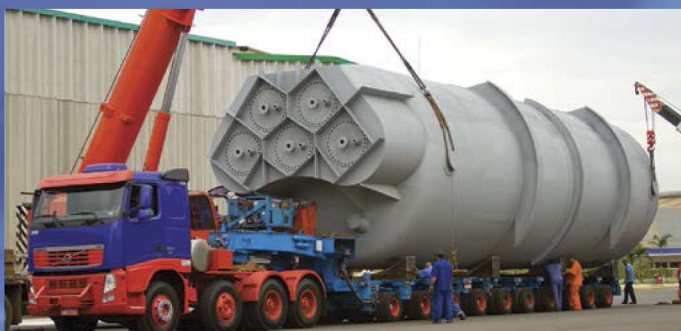
Forno de enxofre, Ø 5.200 mm x 19.800 mm. Peso - 76t.
