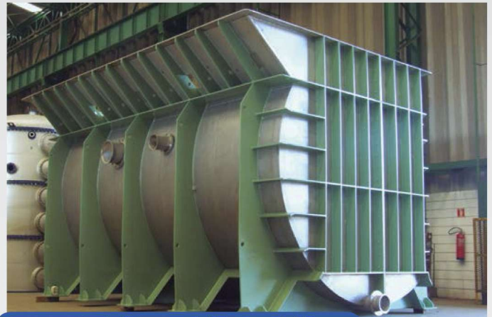
Desagregador, 2.800 mm x 6.800 mm x 3.800 mm.
