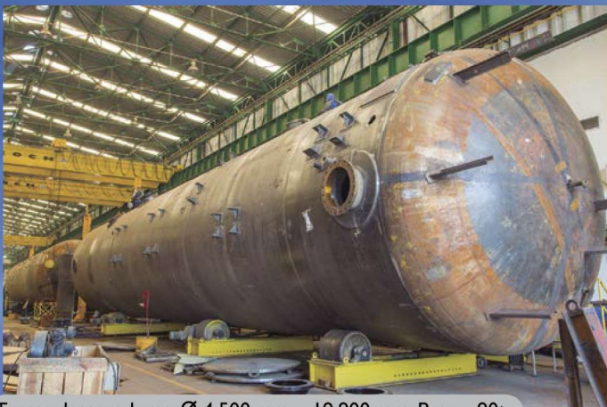
Torres desaeradoras, Ø 4.500 mm x 19.900 mm. Peso - 90t.
