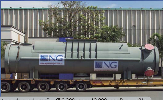
Sistema de condensação, Ø 2.380 mm x 12.800 mm. Peso - 101t.
