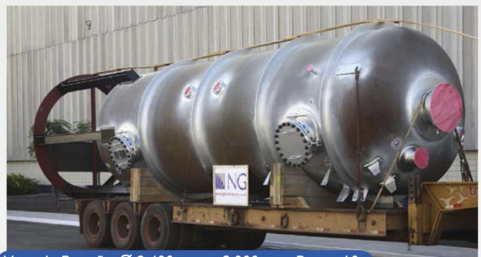
Vaso de Pressão, Ø 2.400 mm x 8.000 mm. Peso - 10t.
