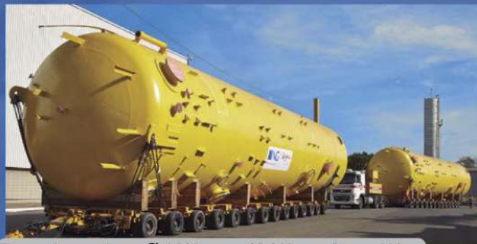
Torres desaeradoras, Ø 4.800 mm x 23.000 mm. Peso - 110 t.
