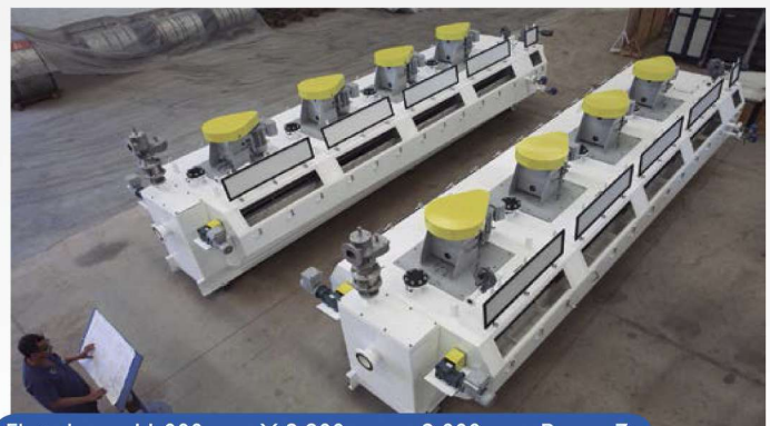
Flotadores, 11.000 mm X 2.900 mm x 2.000 mm. Peso - 7t.
